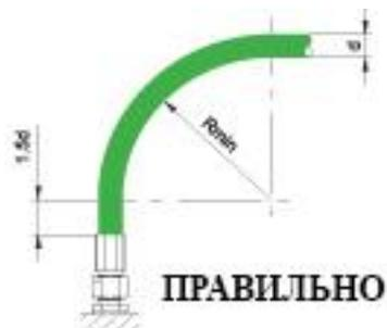
5. Обеспечьте защиту рукава высокого давления от внешних механических воздействий. Наружные элементы могут повредить рукав высокого давления. Необходимо предупредить механический контакт и трение рукавов высокого давления о другие детали или друг о друга. Для этого соблюдайте правильное положение рукава при сборке и фиксации. Если необходимо, защитите рукава пластиковой защитой, детали с острыми краями должны быть закрыты или удалены.
