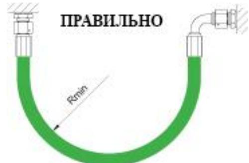
4. Не создавайте изгиб на допускаемый радиус на расстоянии меньше установленного —  $1.5$  размера наружного диаметра рукава. Если рукав высокого давления необходимо согнуть, то длина должна позволить согнуть его под минимальным радиусом. Изгиб должен начинаться на расстоянии  $1.5 d$  от фитинга. Если соблюсти это невозможно, используйте защиту области изгиба.
